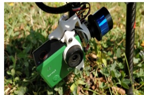
Prinderea camerei multispectrale 3 în stabilizatorul de imagine
