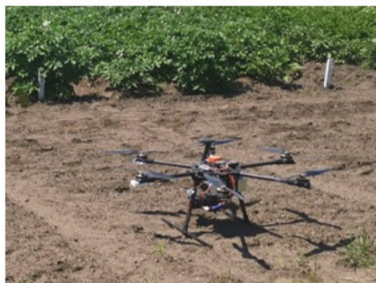
Șistem aerian de monitorizare spectrală de tip dronă agricolă
